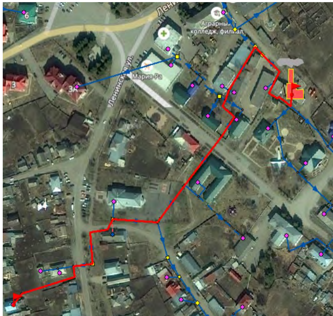
Рисунок 1.3 Путь построения пьезометрического графика котельной «Центральная»
