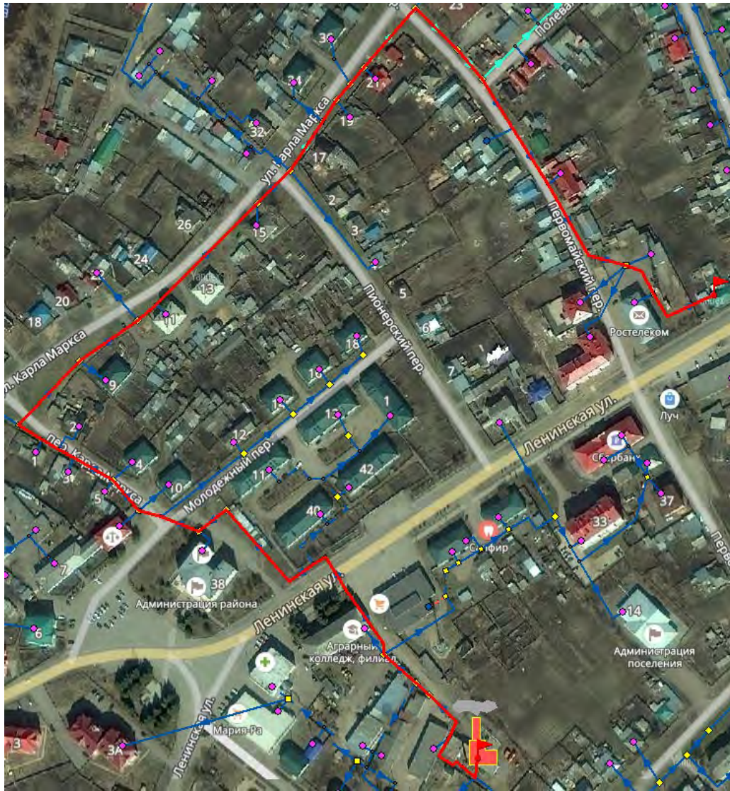
Рисунок 1.19 Путь построения пьезометрического графика котельной «Центральная»
