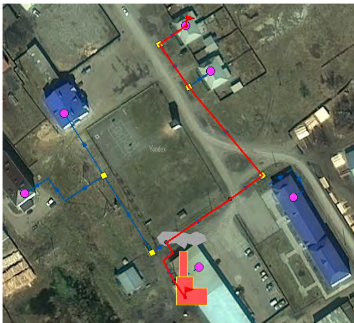
Рисунок 1.45 Путь построения пьезометрического графика котельной «Пожарная часть»
