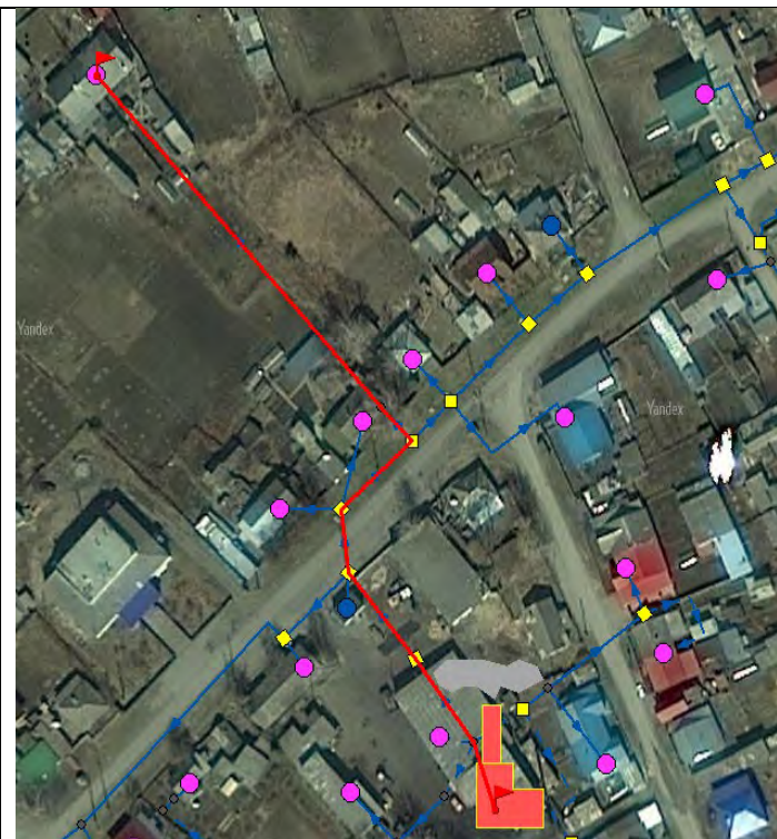
Рисунок 1.23 Путь построения пъезометрического графика котельной «База»
