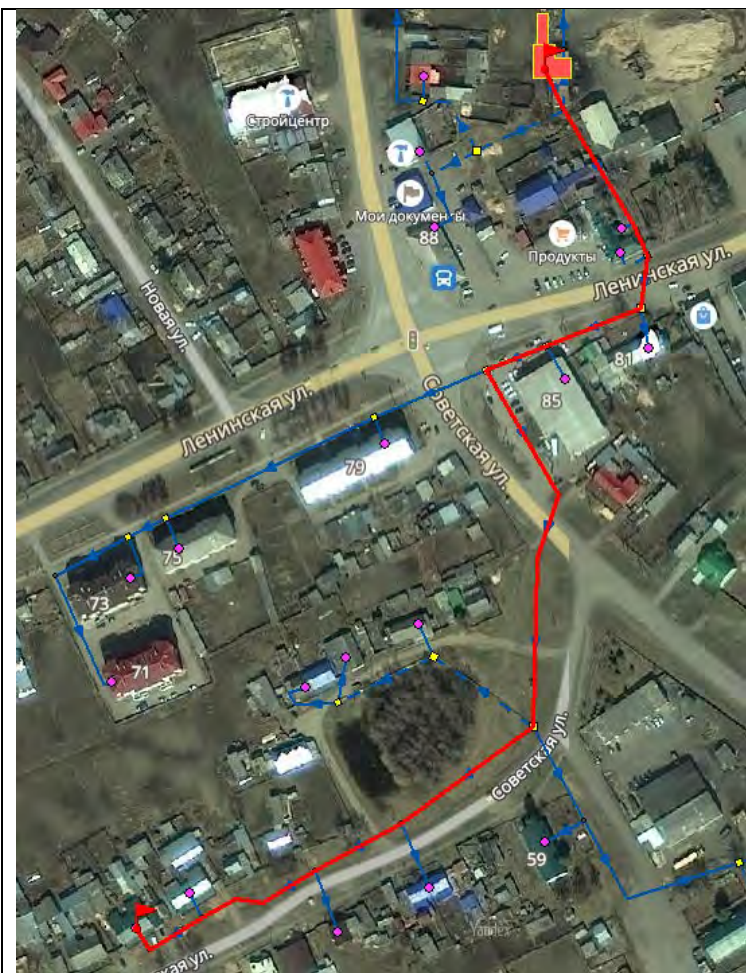
Рисунок 1.39 Путь построения пьезометрического графика котельной «ДРСУ»
