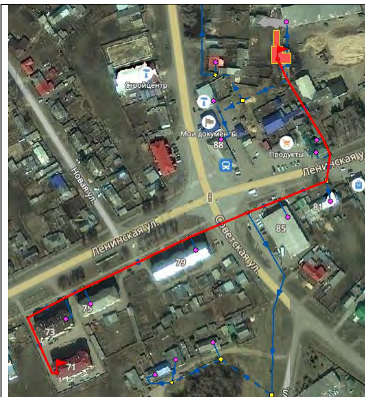
Рисунок 1.35 Путь построения пьезометрического графика котельной «ДРСУ»
